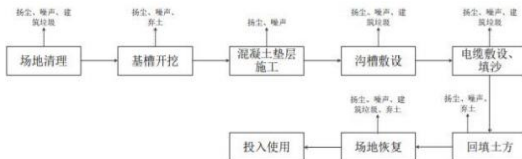
图4-2 地埋电缆敷设施工期工艺流程图
