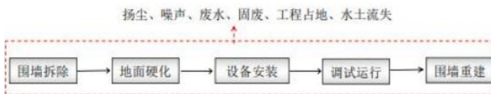
图4-4 出线间隔施工期工艺流程图
