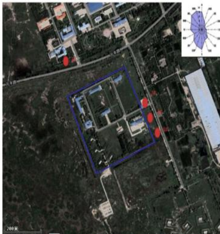
图 1 无组织废气检测点位示意图
