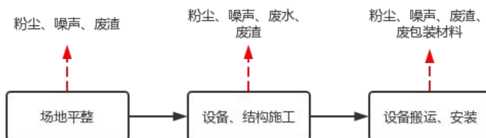
图 3.2-1 施工期工艺流程及产排污流程图
